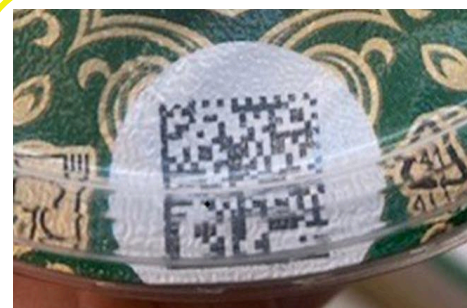
Отсутствие ровного рельефа
