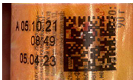
Печать кода маркировки на бликующей/светоотражающей поверхности
