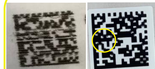
Смазывание кода маркировки или его отдельных элементов
